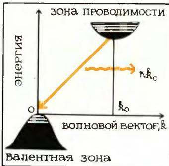
Схема непрямого перехода в электронно-дырочной жидкости полупроводника германия. При таком переходе излучается фонон с импульсом  $\hbar k_0$  ( $k_0 = 1/a$ , где  $a$  — постоянная решетки в германии). Стрелка показывает направление перехода.
