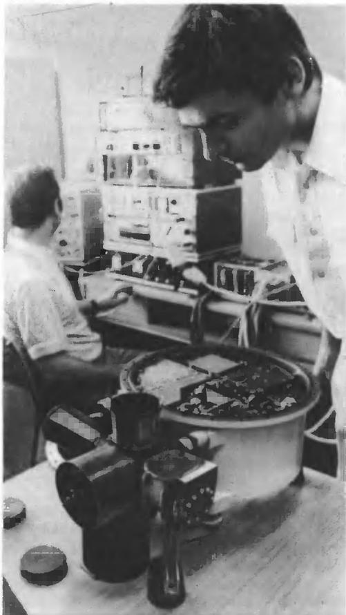
Проверка собранного спектрометра Фурье. С помощью таких спектрометров на метеорологических спутниках определяется изменение влажности и концентрация озона в атмосфере. Институт электроники АН ГДР (Берлин-Адлерсхоф).
