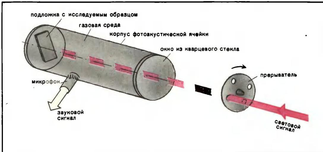
Фотоакустическая ячейка для измерения спектров поглощения вещества. Ячейка состоит из закрытого полого цилиндра с кварцевым окном и теплопроводящим дном, на которое помещается исследуемый образец. Для регистрации звука используется чувствительный микрофон.
